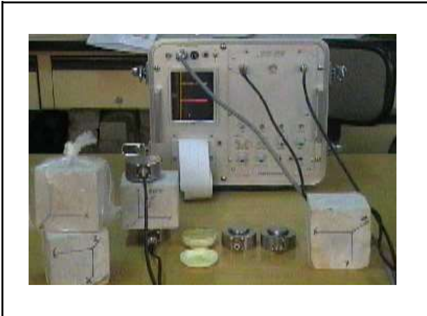
شكل (2 - 4) يوضح كيفية قياس زمن الموجة الطولية والقصية.
